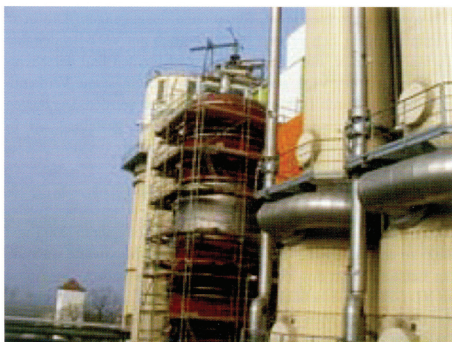
شکل ۳: مقایسه اندازه اوپراتور ریزشی صفحه ای با ریزشی لوله ای
