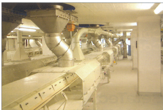
شکل ۷: تخلیه سیلوی کاملاً پوشیده
